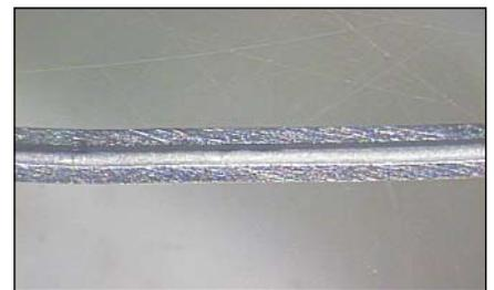
Bild 4: Schliffbild eines Röhrenlots (0,8 mm, Flussmittel 2,5%)
