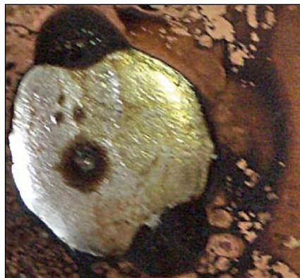
Bild 1: Thermisch überbelastete Flussmittelrückstände (400 °C, 10 s)
