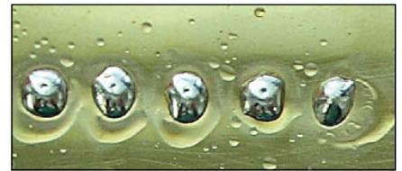
Bild 2: Flussmittelspritzer
