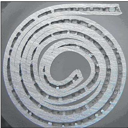
**Bild 5: Schliffbild eines Röhrenlots mit teilweisen Flussmittelunterbrechungen** Quelle: Elsold
