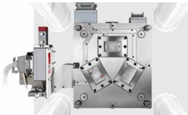
Werkzeug mit angeschlossenem IMKS®-Metallspritzaggregat
