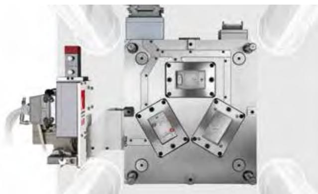
Werkzeug mit angeschlossenem IMKS®-Metallspritzaggregat
